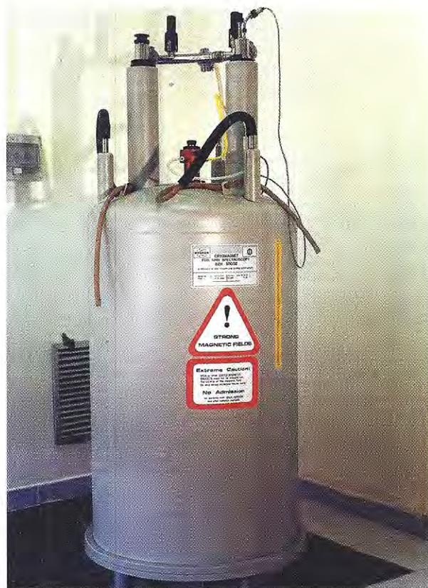
Criomagnete superconduttore operante a 500 Mhz sul protone.
